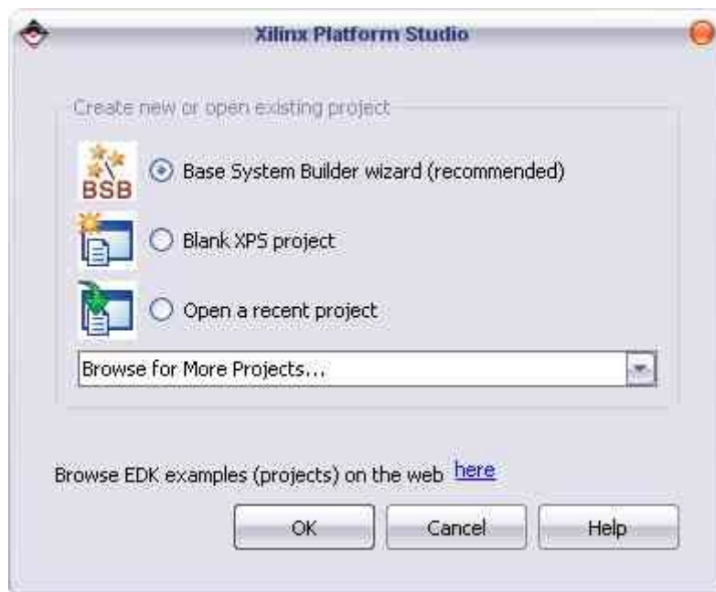
Figure 7 : Création d'un nouveau projet SoPC avec BSB
